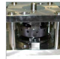
自家設備160tマイプレス用 ダイセット冷鍛用金型
