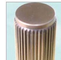
超硬セレーションパンチ 冷鍛金型(コーティング処理)
