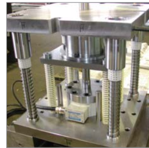
マグネリ開発用試験金型
