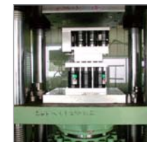
200t試験プレスにてトライ
