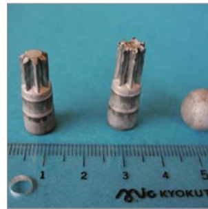
純マグネシウムギア冷間鍛造試作品
